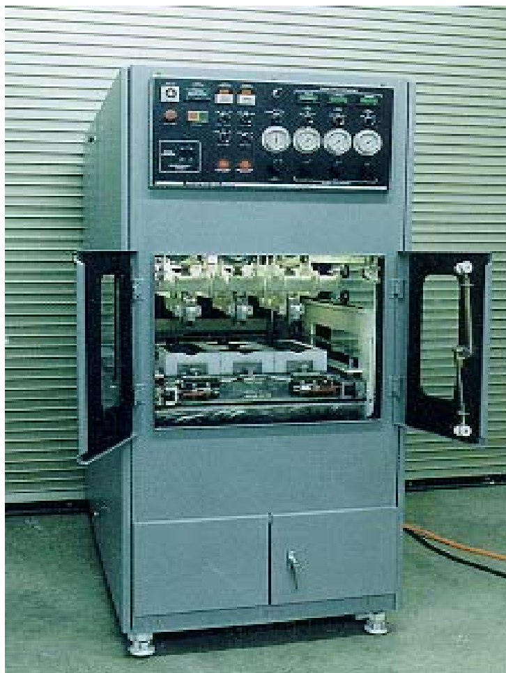
Bild 4.1: Testutrustningen, APA (Asphalt Pavement Analyzer) som kan användas för att utvärdera permanent deformation (spårdjup) och utmattningskänslighet i både torrt tillstånd och i vattenbad
